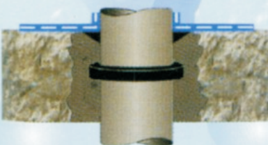
Down Pipe Treatment Xử lý cổ ống thoát nước
